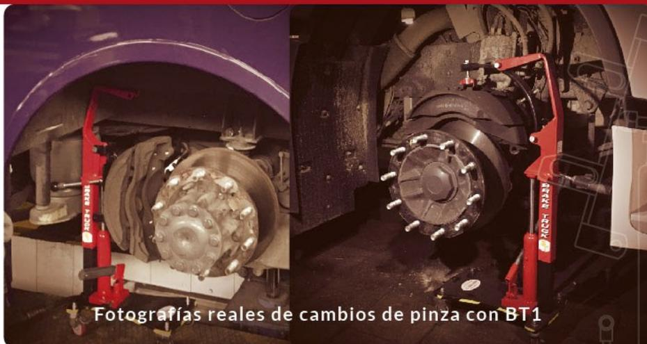
Fotografías reales de cambios de pinza con BT1
