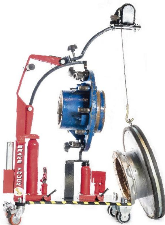
Fotografía real de desmontaje de bujes, pinzas y discos con BT2
