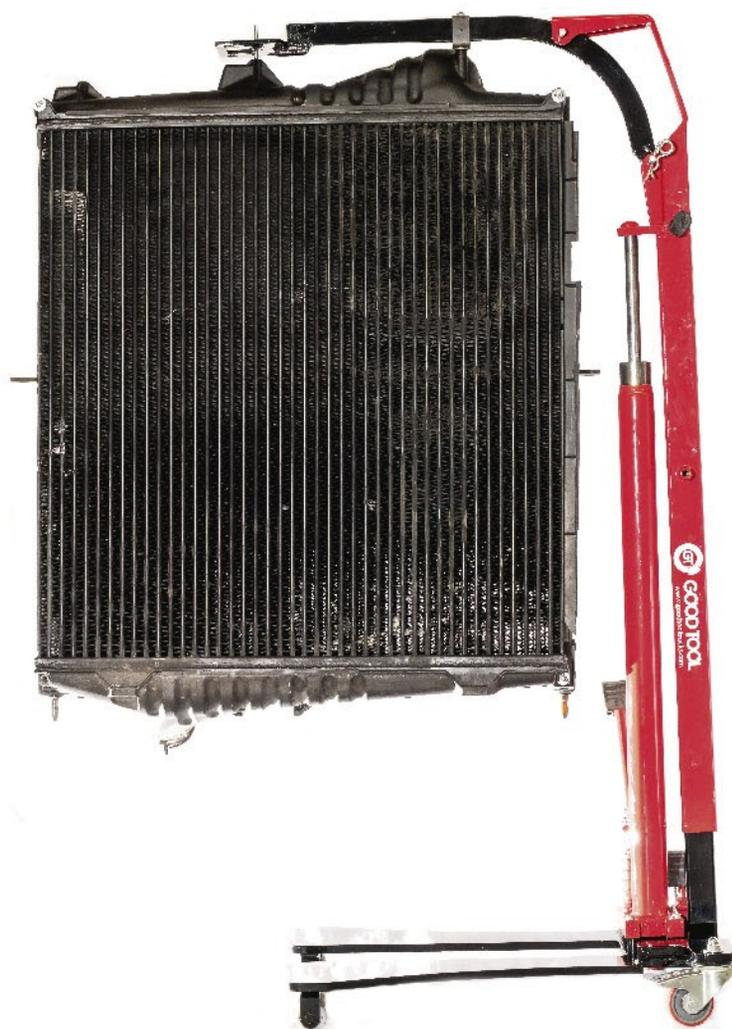
Fotografía real de desmontaje de radiador con RB2
